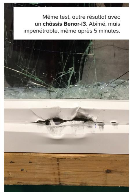
Même test, autre résultat avec un châssis Benor-i3. Abîmé, mais impénétrable, même après 5 minutes.
