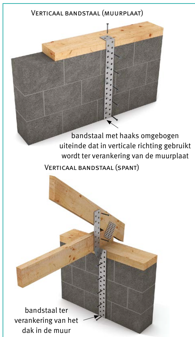
Afb. 25 Voorbeelden van bandstaal.
