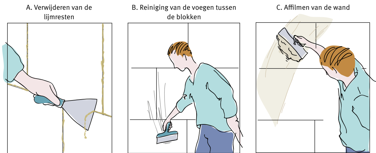
Afb. 60 Uitvoering van een wand uit gipsblokken.
